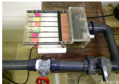
Figura 5. Câmara de natação para investigar as capacidades natatórias das larvas, em condições de fluxo controlado.
